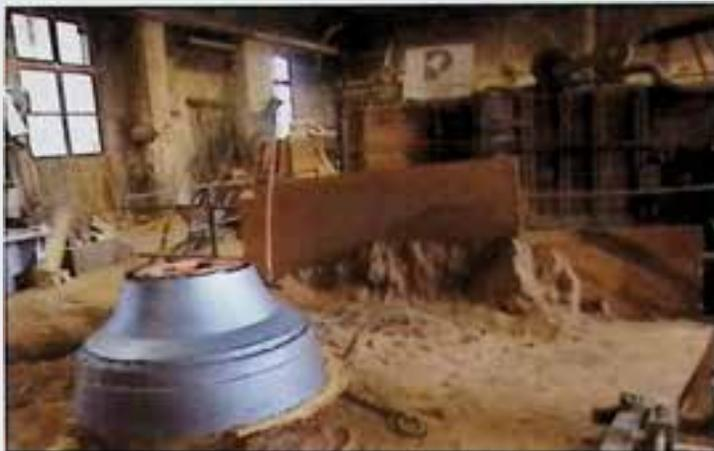
Ein Fragment vom gemauerten Glockenkern nach dem Glockenguss,
