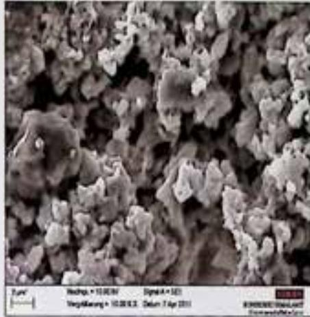
Abb. 13: Trockengelöschter Mörtel REM-SE 3
