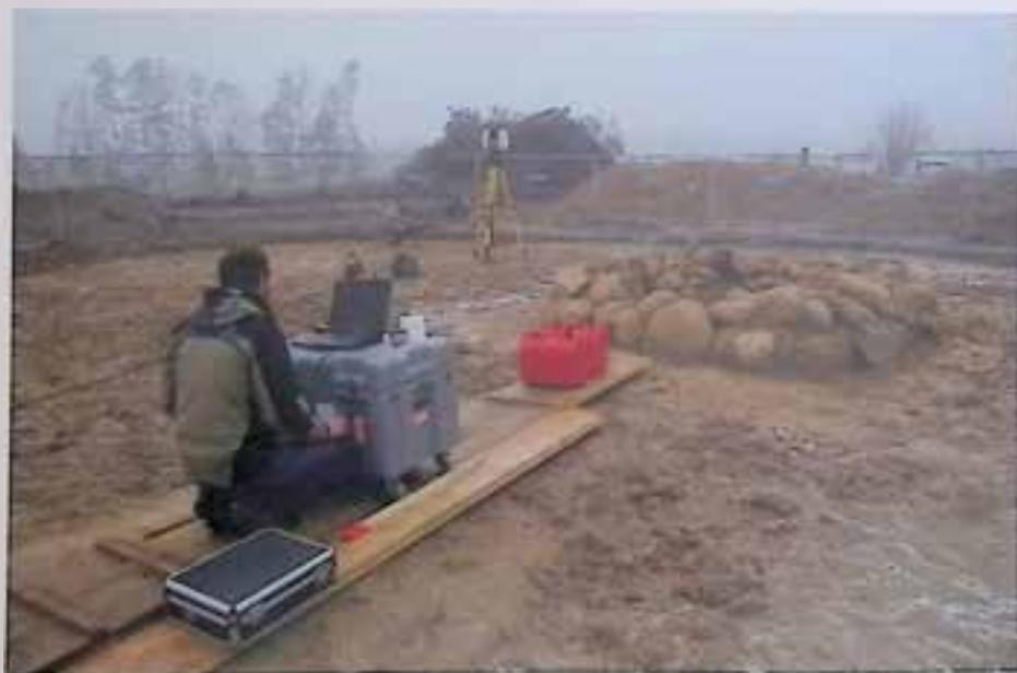
Abb. 4: Dreidimensionale Vermessung eines Steineinbaues mit einem Laserscanner durch das Vermessungsbüro Netz+Plan
